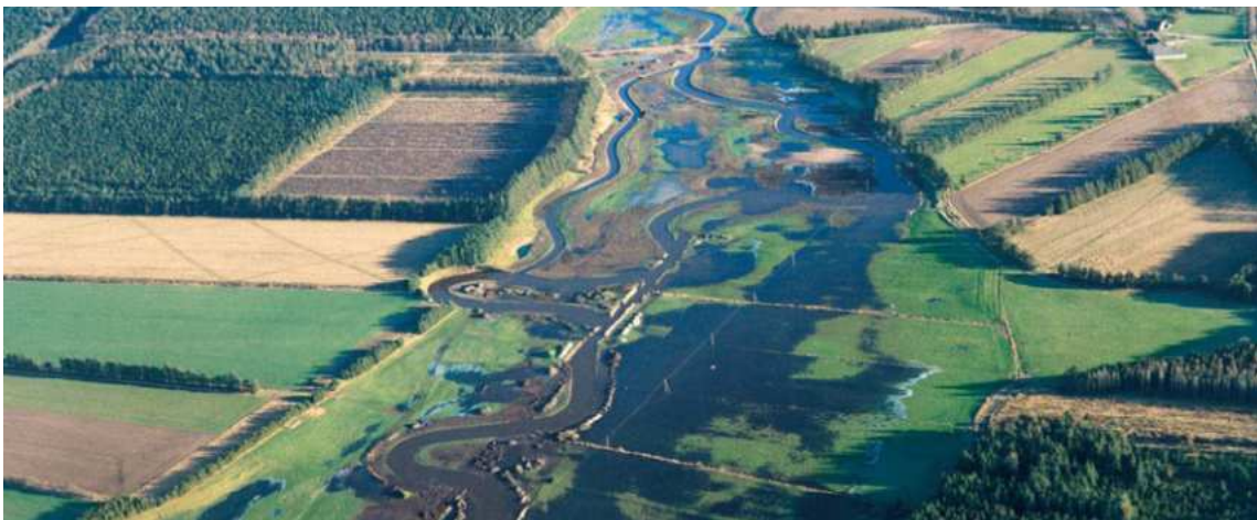
Denemarken - hermeandering rivier de Brede - realisatie in 1998 (Beeld: River Restoration Centre, 1998). Herstel van meanders en overstromingsruimte, nadat de rivier ooit was rechtgetrokken t.b.v. intensieve landbouw.
